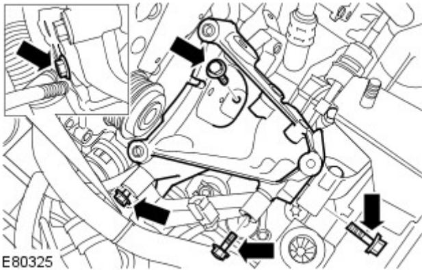
5. 断开冷却液软管，以便卸下螺栓。
